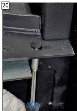
Verschraubung am Blindstopfen an der Bohrung des Türkontaktschalters lösen.
