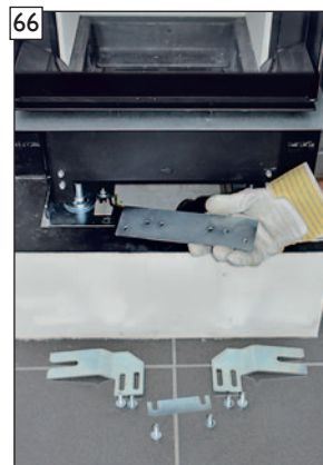
Klemmverbindung des Gleitlagers wieder montieren.
