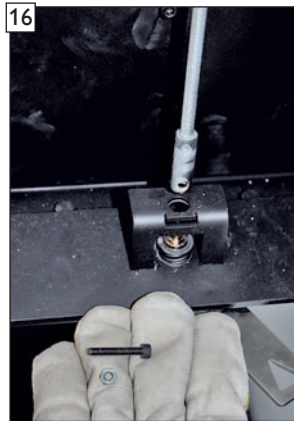
Stellhebelwelle kann nun entfernt werden.
