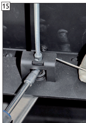
Befestigungsschraube an der Stellhebelhalterung lösen und entfernen.
