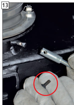
Befestigungsschraube der Steckhülse der Stellhebelwelle abziehen.
