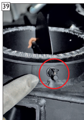
WICHTIG! Die Stellschraube muss zum Einbau der Stellmotorwelle senkrecht nach oben zeigen damit die Zuluftklappe beim Anschluss an den Stellmotor vollständig bis zum Anschlag geöffnet ist. (Montageansicht ohne montierter Zuluftleitung)
