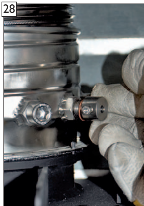
28 Fixierschraube für den Abgastemperaturfühler montieren. HINWEIS! Kupferausgleichsring(e) bei Bedarf verwenden um Fixierschraube in Position zu bringen!
