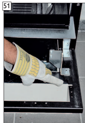
Montageposition für die Status-LED am Blendrahmen.
