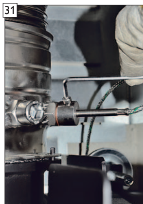
Abgastemperaturfühler mit Fixierschraube sichern.
