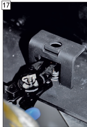
Sprengring vom Stellhebel mit Sprengringzange lösen.
