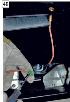
Anschlusstecker wieder auf Verbindungskabel montieren. HINWEIS! Polung des Anschlussteckers ist nicht relevant!
