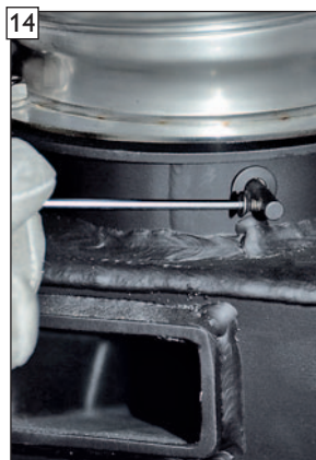
Befestigungsschraube wieder in die Stellhebelwelle einschrauben.
